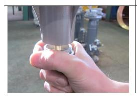
Слегка потянуть колпачок вниз, газ начнет проходить внутри устройства. Когда система заполнится газом, механизм блокировки будет в состоянии взвода.
