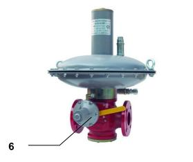
Регулятор давления газа **ALFA** - мембранно-пружинный регулятор давления, приводимый в действие пружиной, усилие которой уравновешивается давлением среды после регулятора, поступающей в корпус регулятора через внешний импульс (1).
